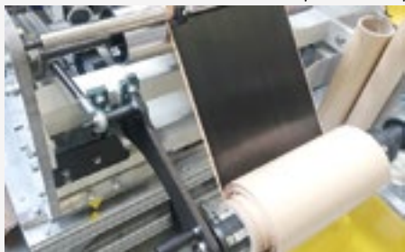
Produkcja próbna jednokierunkowego prepregu realizowana w oparciu o wdrażaną prototypową linię technologiczną
