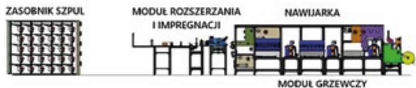
Schemat linii technologicznej do wytwarzania prepregów o niskiej gramaturze wdrażanej w WB Centrum Kompozytów sp. z o.o.
