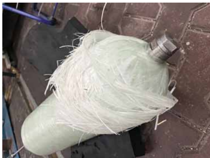
Rysunek 3 Kompozytowy zbiornik po próbie ciśnienia rozrywającego – zniszczenie cylindrycznej części
