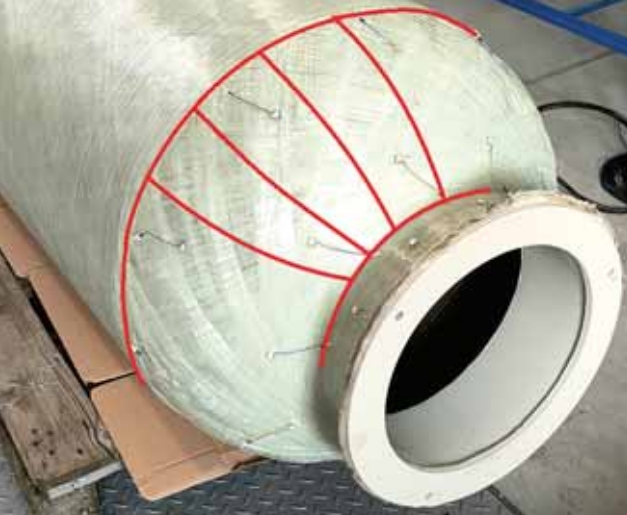
Rysunek 3. Widok zbiornika ciśnieniowego z zainstalowanymi czujnikami PZT oraz z zaznaczeniem przebiegu wybranych połączeń linera Figure 3. View of the pressure tank with the PZT sensors installed and with an indication of the routing of selected liner connections
