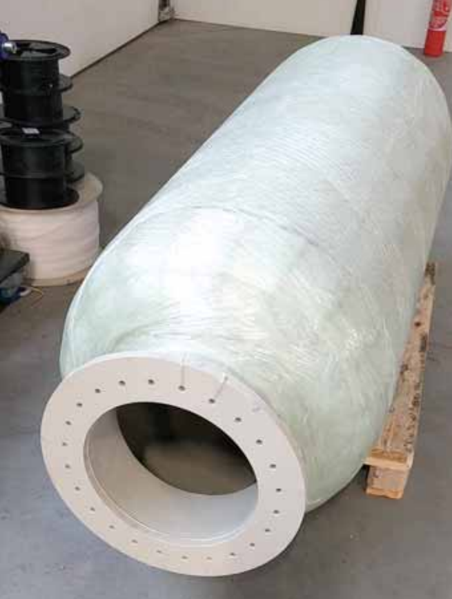
Rysunek 1. Ciśnieniowy zbiornik kompozytowy Figure 1. Pressure composite tank
