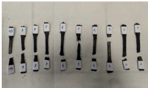
Zdjęcie 3. Kształtki po statycznej próbie rozciągania.
