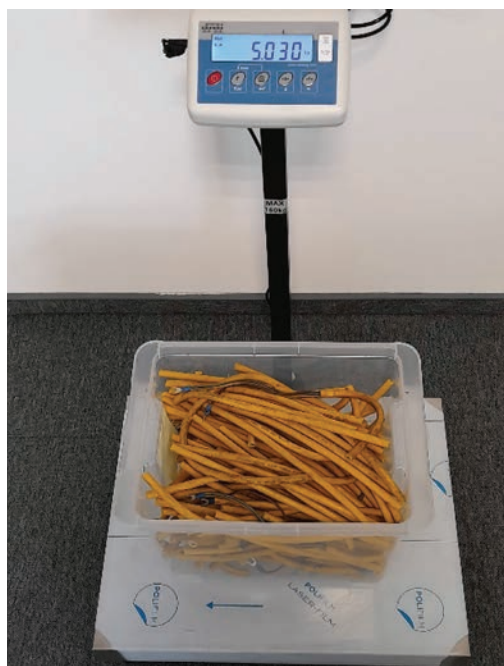
Zdjęcie 1. Próbkę kabla pociętą na odcinki 50 cm.
