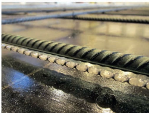
Zdj. 1. Kompozytowy pomiarowy czujnik DFOS firmy Nerve-sensor ułożony wzdłuż zbrojenia stalowego (źródło: https://nerve-sensors.com/product/epsilonsensor/ ).
