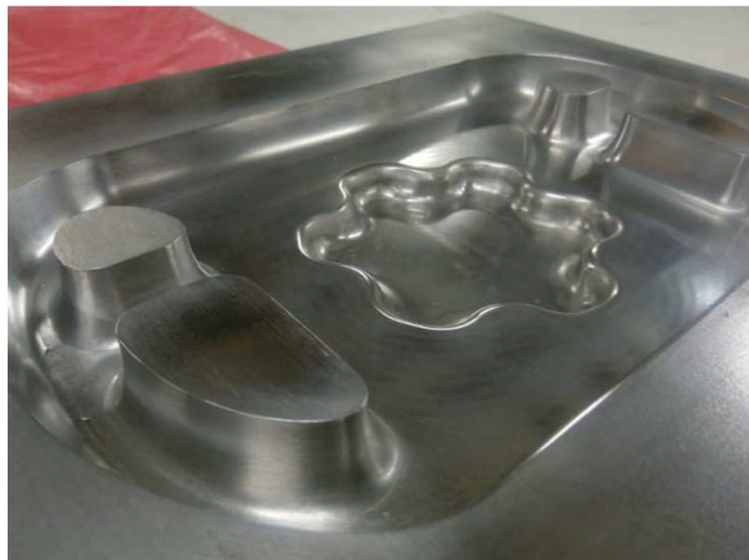
Rys. 4. Aluminiowa forma połowy kierownicy
