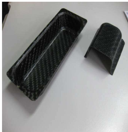
Rys. 8. Wyroby z kompozytów polimerowych otrzymane metodą RPM (a) i metodą TSF (b)
