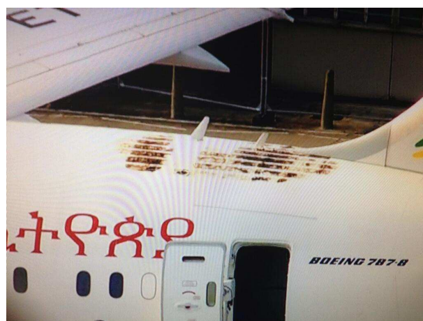
Rys. 4. Uszkodzenie powłoki kompozytowej podczas pożaru instalacji ELT (Emergency Locator Transmitter) na pokładzie B787 linii
