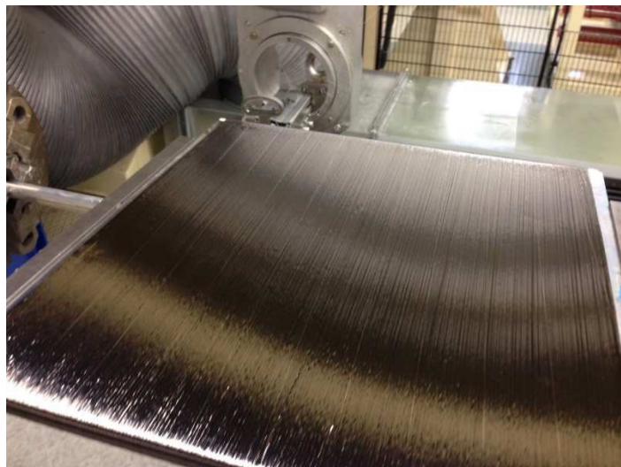
Rys. 5: Nawijanie włókna optycznego na wzmocnienie płyty
