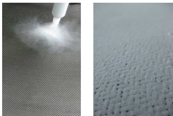
Rys. 4. Nanoszenie proszku żywicy A.S. SET na wzmocnienie
